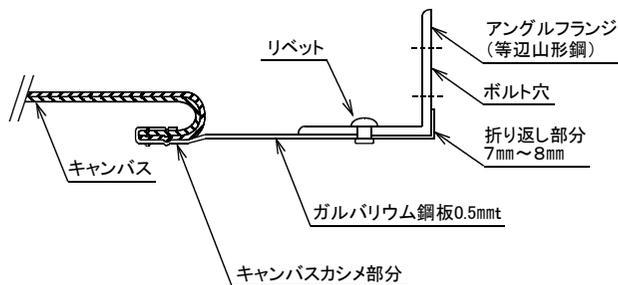
**プレキャン 片側共板・片側フランジダクト用(PTFタイプ) 共板・フランジ加工図**
