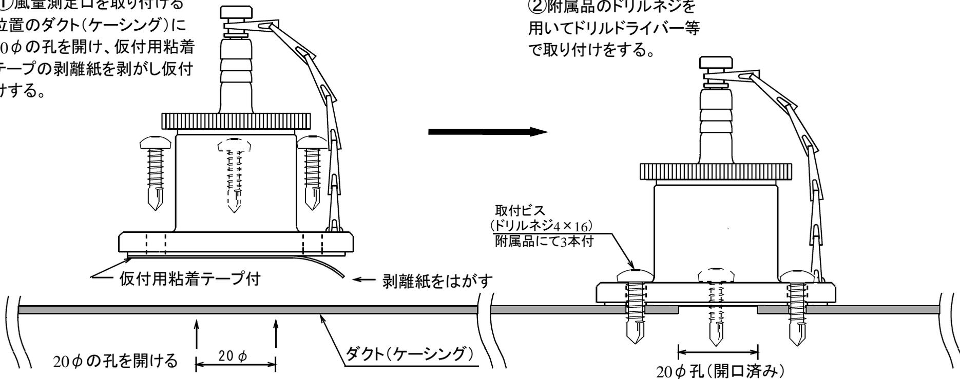
※風量測定口 J-25の図になっていますが J-50、J-25T、J-50Tも同様に取り付けて下さい。
