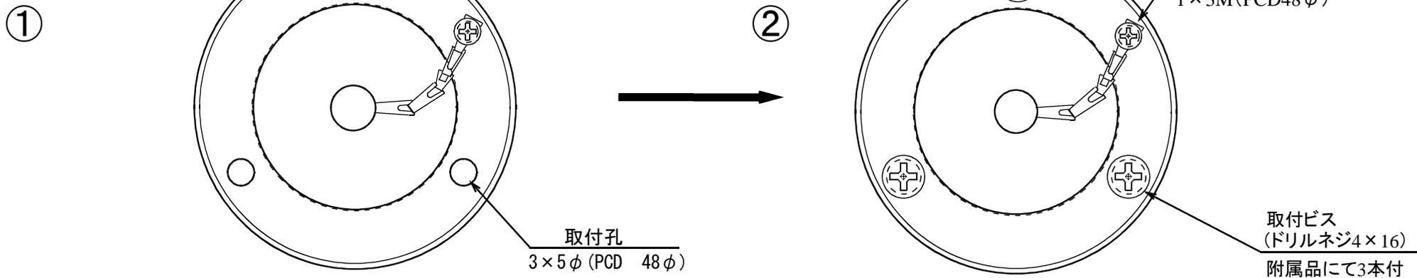
① 風量測定口を取り付ける位置のダクト(ケーシング)に20φの孔を開け、仮付用粘着テープの剥離紙を剥がし仮付けする。
